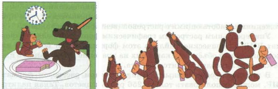
Рис. 3.9. Векторное изображение, его преобразованный фрагмент и простейшие геометрические фигуры, из которых «собирается» этот фрагмент
